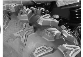
Периодически проводите осмотр износа протектора шины. Когда остаточная высота протектора (а) будет меньше 3 мм, замените шину.
