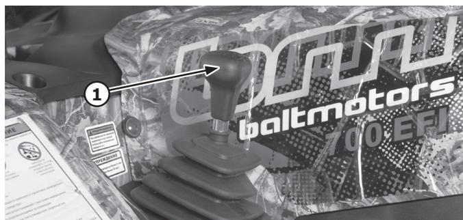
Рычаг переключения передач (1) используется для выбора режима движения вашего квадрицикла: пониженная передача (L)\*, повышенная передача (H), нейтральная (N), передача движения назад (R) и режим парковки (P)\*.
