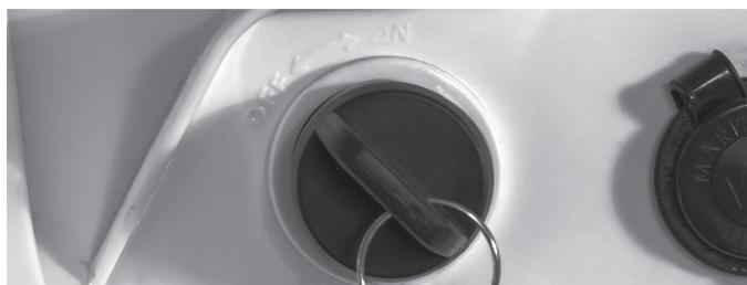
**ON** (зажигание включено) — двигатель может быть запущен в этом положении.
