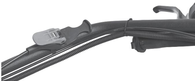
Для включения передачи «назад» остановите мотобуксировщик, уменьшите обороты двигателя и включите парковочный тормоз. Переведите рычаг на руле назад, как показано на фотографии.
