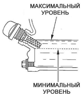
Выкрутите щуп маслосливной горловины и протрите его.
