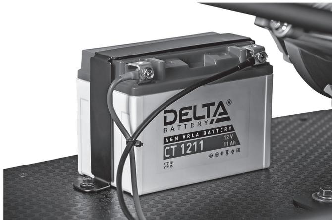
В мотобуксировщик может быть установлен аккумулятор Delta CT 1211 (12V/11Ah) или его аналоги: YT12B-BS, YTZ14S.
