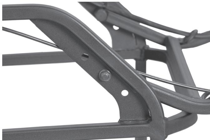
Для удобства эксплуатации предусмотрены регулировочные отверстия высоты установки руля. Для увеличения высоты установки руля установите его в нижнее отверстие.
