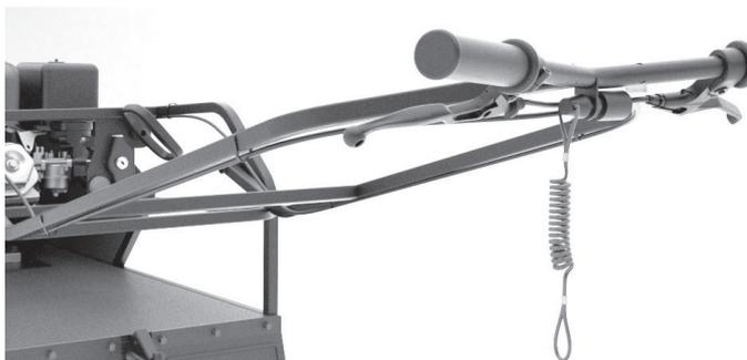
В середине руля находится аварийный выключатель двигателя, который состоит из срывной чеки и кнопки.
