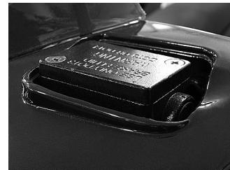
Недостаток тормозной жидкости может указывать на наличие утечки в тормозной системе или на износ накладок тормозных колодок. По этой причине проверьте также тормозные колодки на предмет износа накладок.
